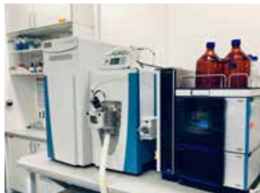
Automatický dávkovač (autosampler) vzorků, který je součástí sestavy kapalinového chromatografu a hmotnostního spektrometru (LC-MS) pro analýzu organických sloučenin
